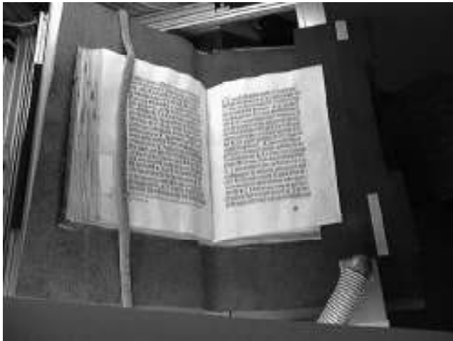
Abbildung 2: Blick auf eine Handschrift. Der rechte Blattrand liegt auf dem Unterdruckarm und wird an diesem leicht festgehalten.
