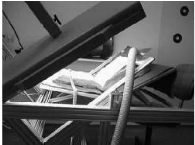
Abbildung 3: Blick von der Seite auf die Buchwippe und den Unterdruckarm
