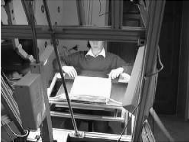
Abbildung 4: Der Bearbeiter sitzt immer dem Vorderschnitt zugewandt und kann daher gefahrlos mit beiden Händen umblättern
