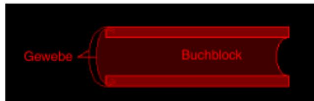
Abb. 3: Die Gewebeflügel werden in der Fräsnut des jeweiligen Deckels verklebt.
