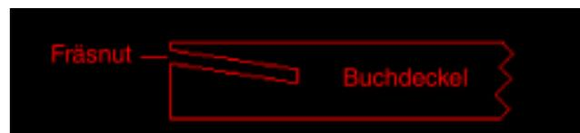
Abb. 2: Der schräg eingefräste Buchdeckel: die Fräsnut fängt direkt unter dem Leder an und reicht bis zur Mitte der Deckelstärke
