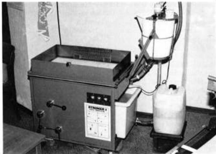
Abbildung 8: Anfasergerät Stromer I mit Zusatzbehälter
