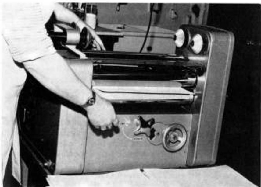
Abbildung 11: „Gautschen“ der angefaserten Objekte mit der ehemals zu Kaschierzwecken verwendeten Hennecke-Maschine
