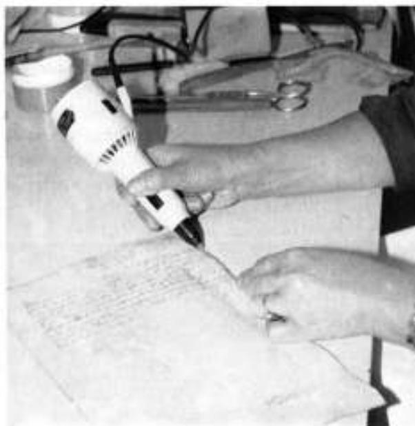
*Abbildung 2: Reinigung mit Radiermaschine*
