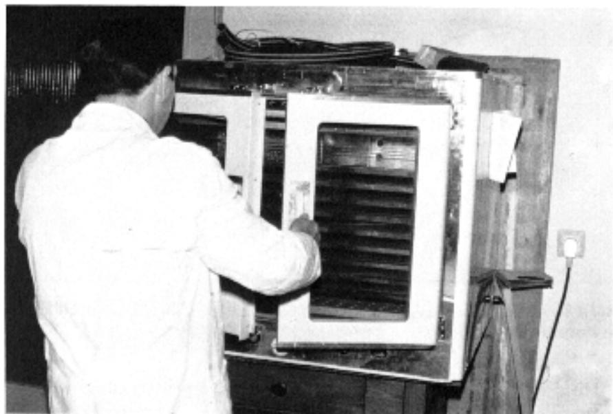
*Abbildung 4: Filmbildung im Trockenschrank bei mindestens 40°C. Es ist zweckmäßig, den Thermostat des Schrankes auf eine höhere Temperatur (65°C) einzustellen*
