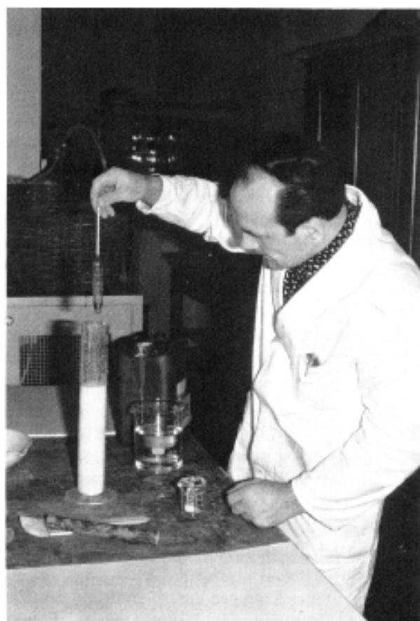
Abbildung 1: Mit einem Aräometer wird die Dichte (Konzentration) der Acrylharz-Dispersion überprüft.
