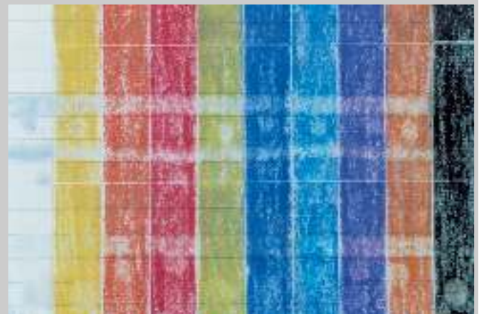
7 Pastellmalerei auf Pergament: Die locker aufliegenden Pigmente werden durch den Laserstrahl abgetragen. Links: etwas verschwärztes Bleiweißpigment. Laserenergien (von oben nach unten): 2x1 J, 1x1 J, 3x1 J (532 nm); 1x1 J, 2x1 J (1064 nm).
