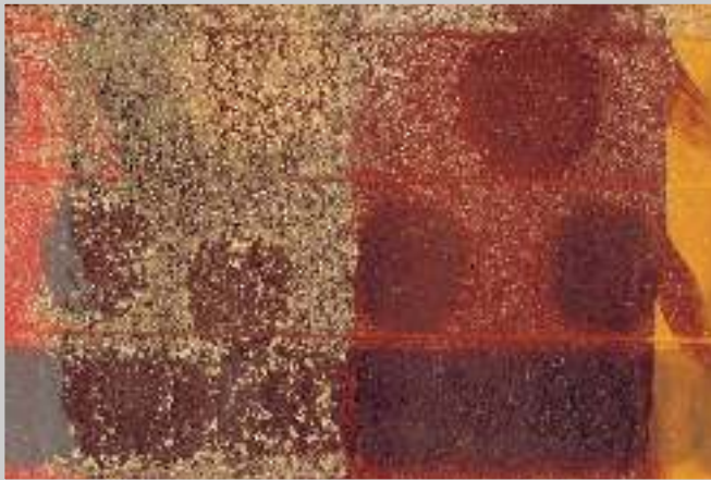
4 Vermalte Ockerpigmente auf Pergament (Bindemittel: Gummi arabicum), mit Staub verschmutzt: Der gelbe und rote Ocker rechts wurde durch dem Laserstrahl zu braunem Ocker umgewandelt.
