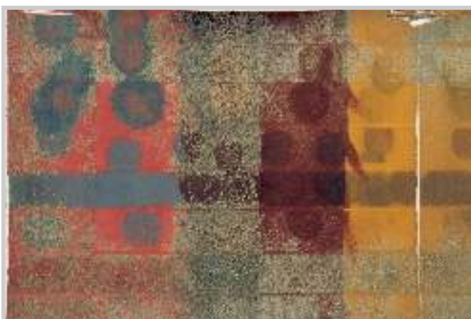
10 Malprobe auf Pergament (von links): 2 Streifen Zinnober (Hausenblase, Gummi arabicum), 2 Streifen brauner Ocker (Hausenblase, Gummi arabicum), 2 Streifen gelber Ocker (Hausenblase, Gummi arabicum). Die Pigmente werden durch den Laserstrahl verändert: Zinnober wird metallisch schwarz, der Ocker dunkelbraun. Die Laserenergie wurde verändert (von oben): 1x1 J, 2x1 J, 5x1 J bei 1064 nm; 1x1 J, 3x1 J bei 532 nm. Einige Laserreaktionen zeigen die konzentrischen Streifen des nicht homogenisierten Laserstrahles.
