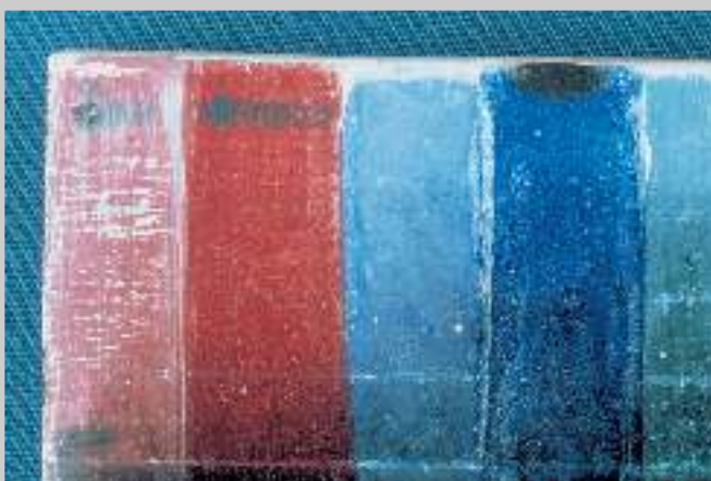
8 Wandmalereiprobe (von links): Zinnober freskal vermalte, Zinnober mit Casein, Smalte freskal, mit Casein, Azurit freskal vermalte. Die Zinnoberproben links wurden durch das Infrarot-Heizgerät geschwärzt. Nur das Casein der Smalteprobe wurde durch die zu große Hitze schwarz verkohlt. Das Azurit wurde nicht behandelt.
