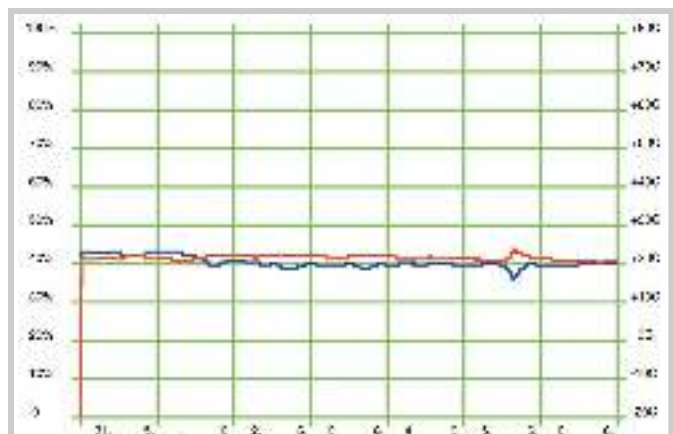
8 Innerhalb der Vitrine aufgezeichnete Klimadaten (31. Mai bis 6. Juni 1999): Temperatur (rot), rF (blau); Peak am 5. Juni 1999 durch hohe Besucherzahl. © Microtool.
