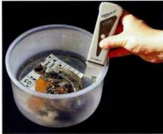
Figure 3: Measuring salt content of wash water with hand held conductivity meter. Credit: ©2002 Institute of Nautical Archaeology Resim 3: Tuzdan arındırma için kullanılan suyun tuz içeriğinin kondüktivite metre ile ölçümü. Fotoğraf: ©2002 Institute of Nautical Archaeology / Sualtı Arkeoloji Enstitüsü
