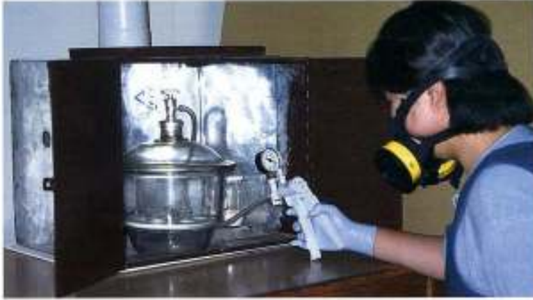
Figure 2: Treatment of bronze disease with benzotriazole under vacuum pressure, within safety chamber. Kaman-Kalehöyük, Turkey. Credit: Glenn Wharton Resim 2: "Bronz hastalığı"nın benzotriazole çözeltisi ile vakum altında ve çeker ocak içinde muamelesi. Kaman-Kalehöyük, Türkiye. Fotoğraf: Glenn Wharton
