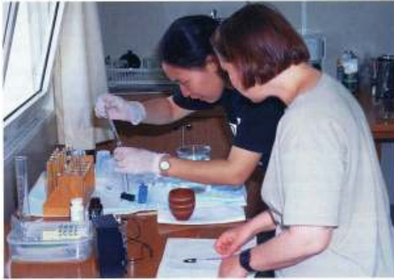
Figure 3: Measuring the conductivity of bath water during the desalination of excavated ceramics. Kaman-Kalehöyük, Turkey. Resim 3: Kazıda bulunan seramik objelerin tuzlardan arındırılma işlemi sırasında banyo suyunun iletkenliğine ölçümü. Kaman-Kalehöyük, Türkiye. Credit: Glenn Wharton
